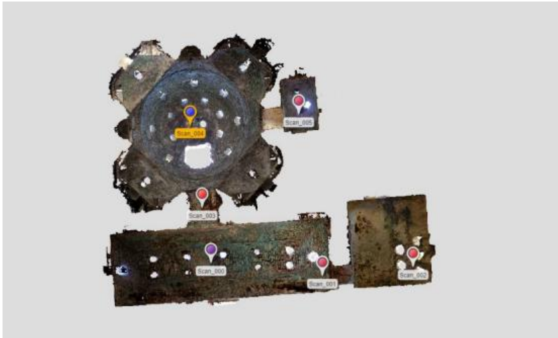
Εικόνα 7: Κάτοψη θέσεων σάρωσης εσωτερικά του λουτρού
